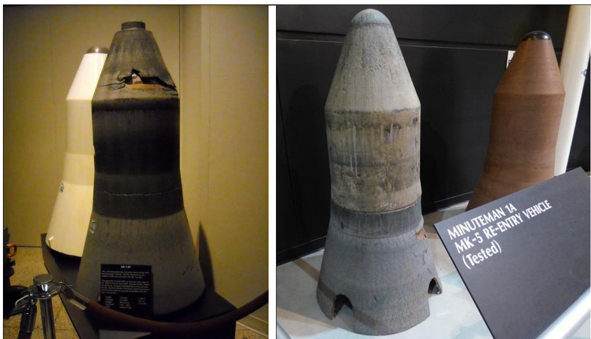
تصاویر بازآی (سرجنگی) MK-5 مربوط به موشک بالستیک مینتمن-۱ پس از بازیابی از آزمون پروازی
