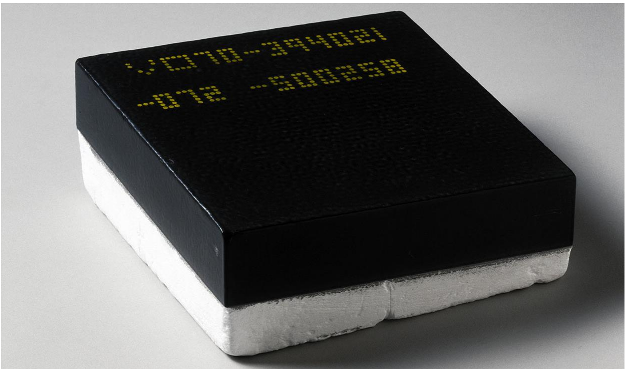
موزائیک صلب سیاه LI-900 که بر روی شاتل فضایی به کار گرفته شد. آغشته شدن به حرارت
